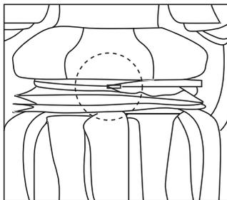
**Шаг 3:** Подключите провод прогрева спинки и провод вибрации сиденья.
