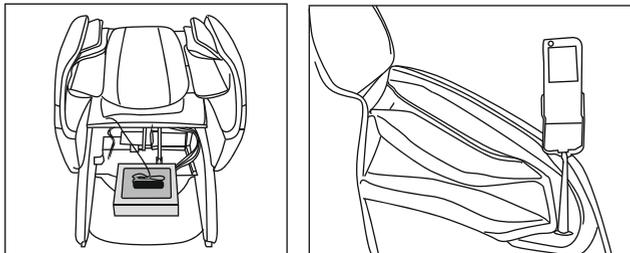
**Шаг 5:** Извлеките болт и фиксирующий шплинт из U-образного привода спинки и отложите их в сторону.
